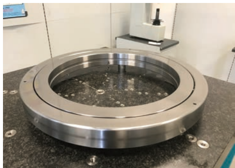
I cuscinetti a rulli incrociati di precisione sono caratterizzati da due set di piste e rulli accoppiati con il giusto angolo con le facce dei rulli alternate in direzione opposte
