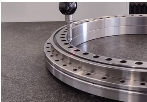
I cuscinetti radioassiali e assiali a sfere a contatto obliquo sono cuscinetti di precisione pronti per il montaggio per applicazioni con carichi combinati. Assorbono infatti carichi radiali e assiali bidirezionali e momenti di ribaltamento senza gioco
