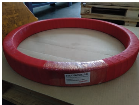
I cuscinetti a rulli incrociati sono adatti per applicazioni oscillanti e basamenti dove lo spazio è limitato o si richiede il più basso centro di gravità possibile della massa rotante
